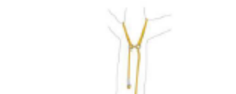
Fig. 8 - Ancoraggio passante per corda raddoppiata
