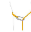
Fig. 2 - Strozzo diretto della fune
